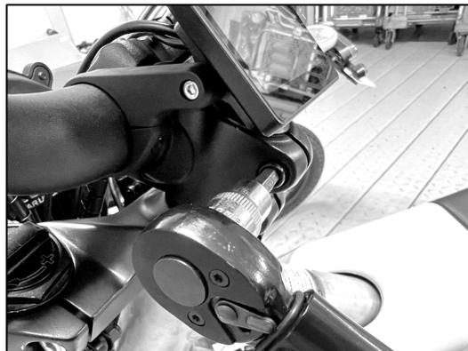
・ハンドルバーのセンターを確認後、ステムの左右のボルトを交互に締めて固定してください。(14Nm)
