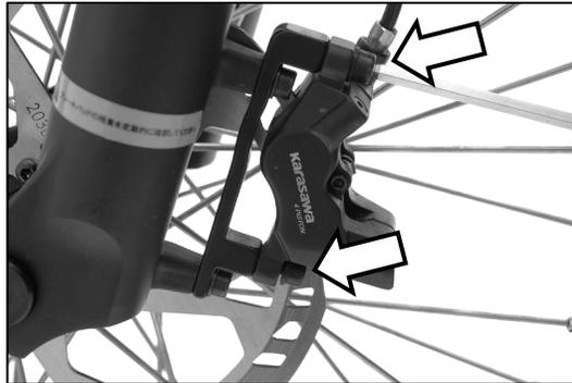
・フロントブレーキレバーを操作し、握った状態でキャリパーの固定ボルトを上下交互に締め込んでください。 (8N.m)
