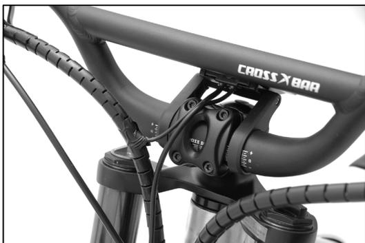
・ステムの仮止めボルトを外し、ハンドルバーをステムにセットします。
