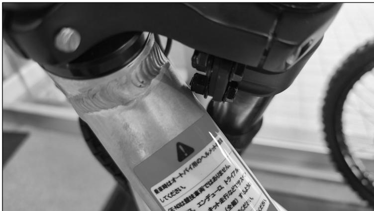
・ヘッドランプを固定する位置が高すぎたり低すぎたりすると、写真のようにナットとフレームが干渉する場合があります。真ん中あたりの位置で、フレームとの干渉を回避する位置を選んでから固定してください。
